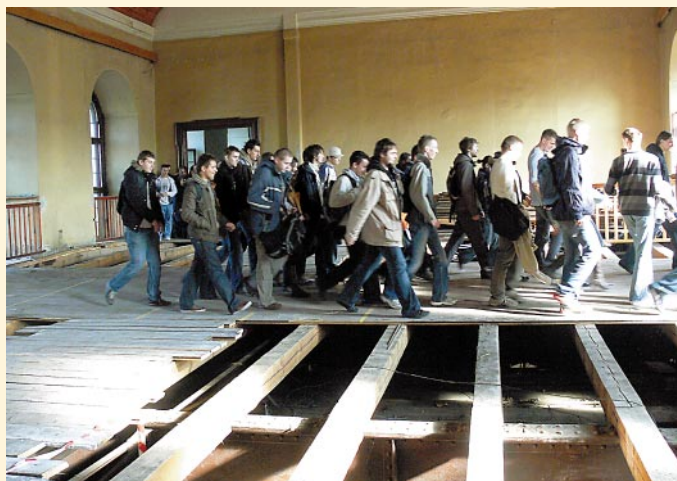
Symulacja obciążenia dynamicznego stropu (swobodny ruch pieszy)
