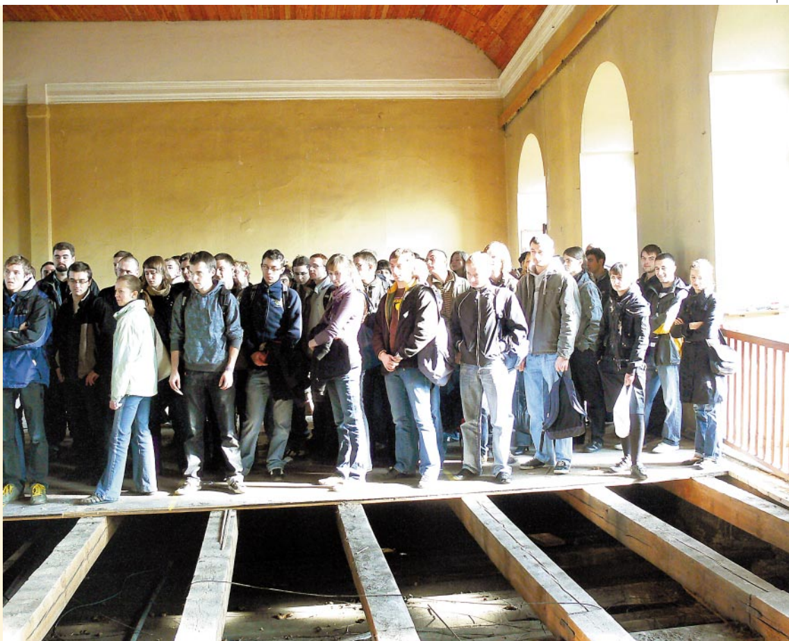
Widok studentów obciążających strop (symulacja obciążenia statycznego)
